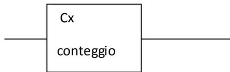
I suoi parametri sono l'indirizzo del contatore Cx e il valore da raggiungere nel conteggio. Si possono avere più contatori in cascata. Se il rung dove si trova il contatore subisce una transizione falso - vero il contatore incrementa di un'unità, in questo caso per resettare si utilizzerà l'istruzione opportuna disponibile dal programma che si utilizza.
