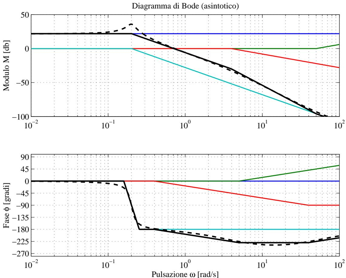
3. (3 punti) Si discuta se tale diagramma ha il significato fisico di risposta armonica. Si determini, se esistono, i valori dei seguenti parametri: modulo e pulsazione alla risonanza, e banda passante.
