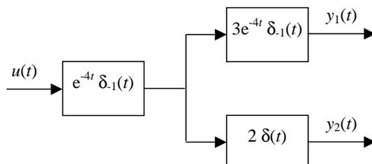
1. (4 punti) Si determini la matrice di trasferimento tra l'ingresso  $u(t)$  e l'uscita  $\vec{y}(t) = \begin{bmatrix} y_1(t) & y_2(t) \end{bmatrix}^T$ .
