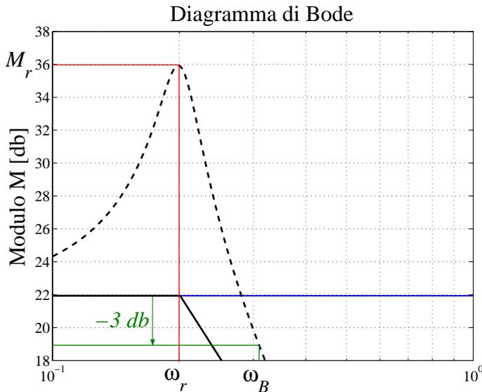
Il modulo e la pulsazione alla risonanza possono valutarsi in corrispondenza al punto di massimo della curva dei moduli. Essi valgono:  $M_r = 36$  db e  $\omega_r = 0.2$  rad/s.
