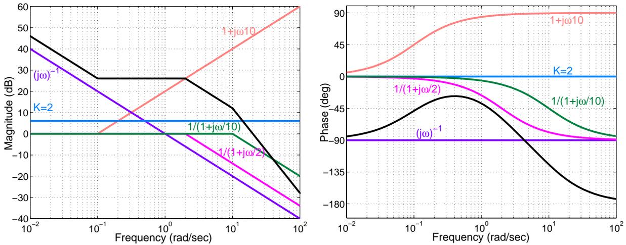
Figura 2: Diagramma asintotico di Bode dei moduli (a) e diagramma delle fasi (b).
